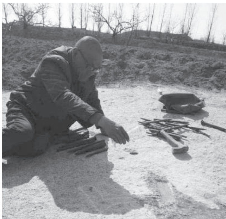
図22. 45号炭鋼鑿を使い花崗岩彫刻定量化テスト中の石工の杜洪軍氏（筆者撮影）
