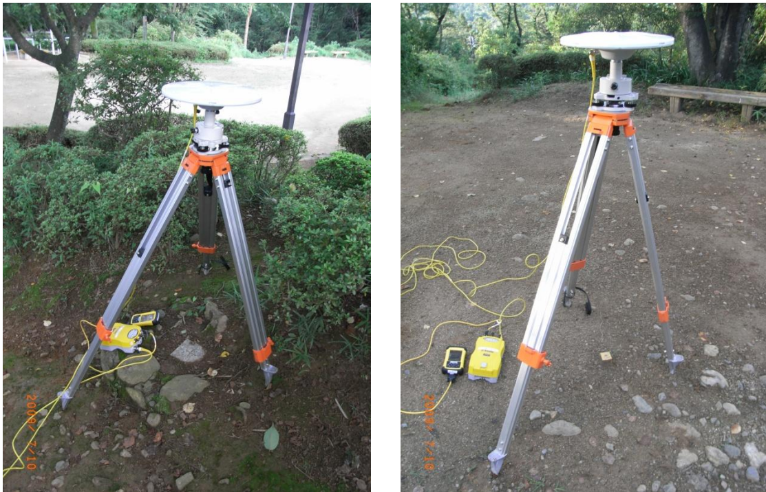
図 3-11 RTK GPS 測量（左：国家基準点，右：後視点）
