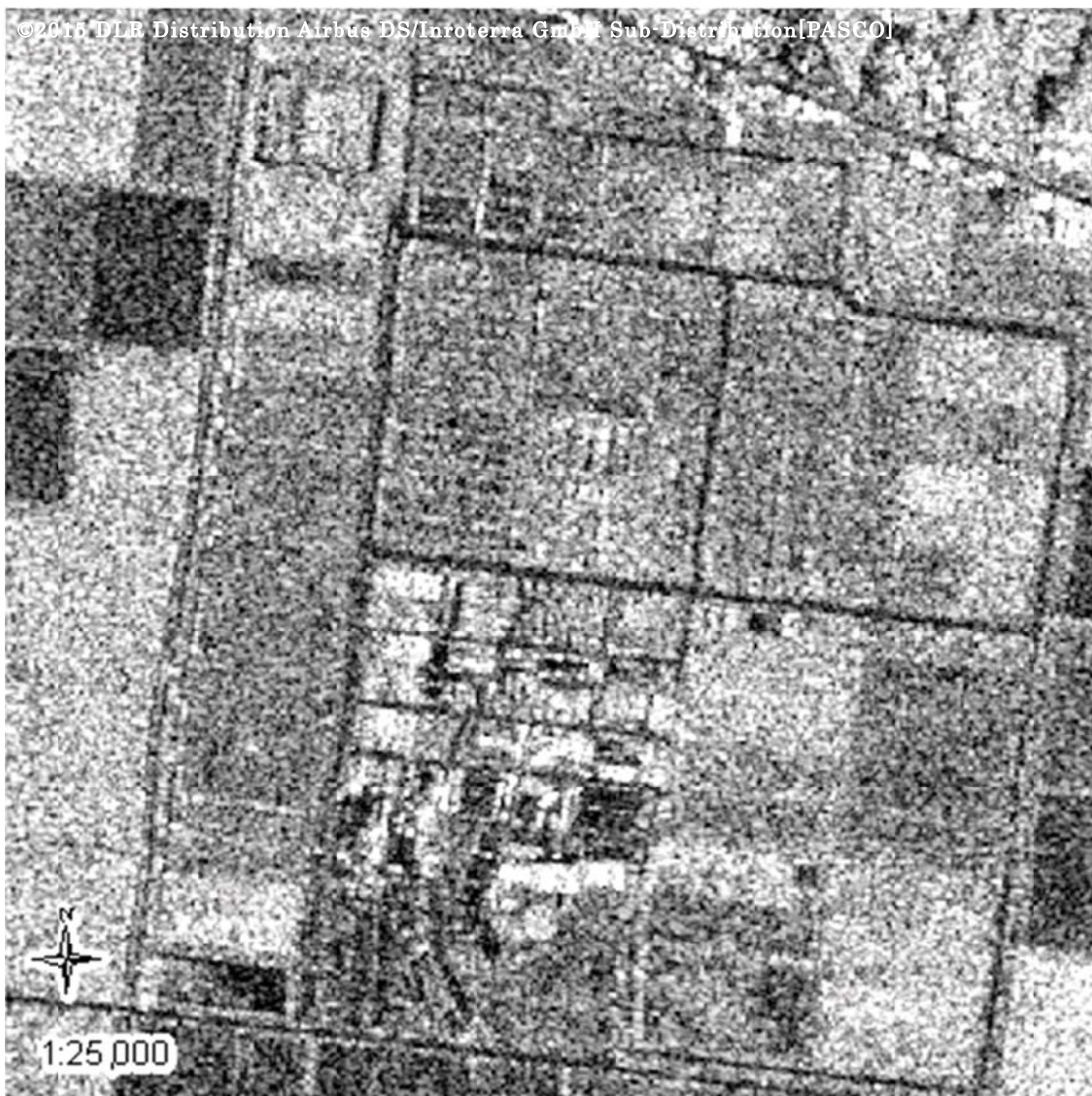
図 4-7 入射角 21 度の VV 偏波の後方散乱係数画像（8 月上旬：DOY224）
